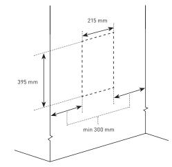
Installieren Sie den Tresor mit der gewählten Installationsmethode(A)oder(B)
